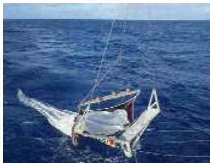
Großes Maul und viel dahinter: Das „Isaac Kidd Midwater Trawl“ ist mehr als 2 Meter breit und 8 Meter lang. Ein Gerät ähnlich dieses Typs wurde verwendet.
